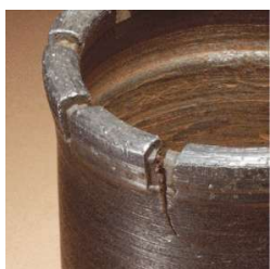
FISSURES DANS LES SEGMENTS
