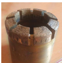
USURE EXTÉRIEURE DE LA COURONNE
