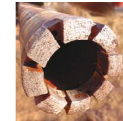
COURONNE POLIE La couronne ne coupe plus, les diamants sont polis. Cause : appui trop faible par rapport à la vitesse de rotation, débit d'eau trop élevé, utilisation d'un indice de matrice trop faible (matrice trop dure). Solution : affûter la couronne, réduire la vitesse de rotation et augmenter l'appui, réduire le débit d'eau, utiliser une couronne d'indice plus tendre.
