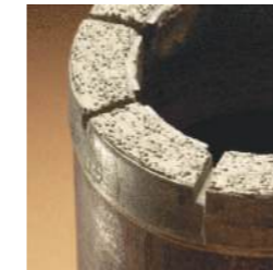
DIAMANTS SUREXPOSÉS : La matrice s'use trop rapidement, avant même que les diamants n'émergent, réduisant ainsi la durée utile de la couronne. Cause : appui trop élevé par rapport à la vitesse de rotation, débit d'eau trop faible, matrice trop tendre.
