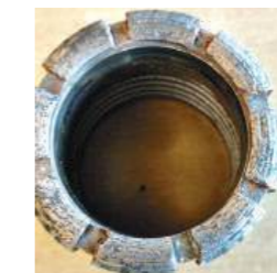
PERTE DE DIAMÈTRE INTÉRIEUR Usure de la paroi et du baguage internes. Cause : appui trop élevé, terrain très accidenté, couronne laissée dans le forage, débit d'eau trop faible, matrice trop tendre.
