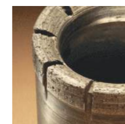
USURE INTÉRIEURE DE LA COURONNE : Cause : appui trop élevé par rapport à la vitesse, la carotte laissée dans le forage a dû être percée, le terrain est très accidenté. Solution : diminuer l'appui, augmenter la vitesse de rotation, vérifier le carottier, ajouter un fluide de forage (terrain fissuré).
