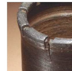
FISSURES DANS LES SEGMENTS Cause : poids trop élevé sur la couronne (appui trop fort), chute des tiges dans le forage, couronne écrasée dans le frein de tiges. Solution : diminuer l'appui sur la couronne.
