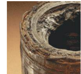
COURONNE BRÛLÉE La couronne est entièrement fondue et dégradée. Cause : manque d'eau. Solution : augmenter le débit d'eau, vérifier le fonctionnement de la pompe, vérifier que les tiges ne fuient pas aux raccords de serrage, vérifier le réglage du tube intérieur du carottier pour s'assurer qu'il n'est pas trop long.
