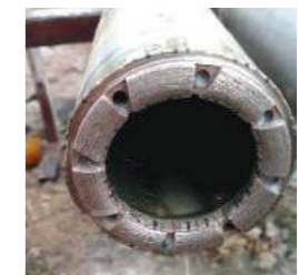
PERTE DE DIAMÈTRE EXTÉRIEUR Usure du diamètre externe. Cause : vibration, vitesse de rotation trop élevée, débit d'eau trop faible, présence de fragments de roche libres dans le forage. Solution : augmenter le débit d'eau, réduire la vitesse de rotation, vérifier le diamètre du manchon aléuseur, ajouter un fluide de forage (pour réduire la vibration).
