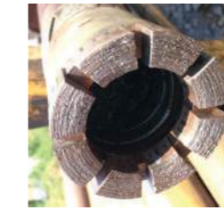
USURE NORMALE Usure uniforme, complète jusqu'au carbure, diamants usés de façon uniforme.
