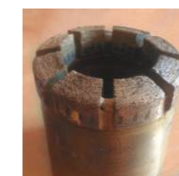
USURE EXTÉRIEURE DE LA COURONNE Cause : débit d'eau trop faible, fuite d'eau par les tiges, diamètre du forage surdimensionné. Solution : augmenter le débit d'eau, vérifier la présence de fuites, vérifier le diamètre du manchon.
