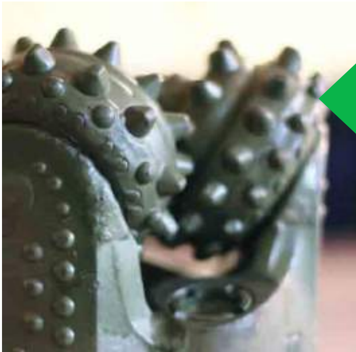
THE «BLUE» TRICONE BIT : SEALED BEARING
